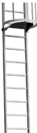
Ostacolo anti-salita in lamiera di alluminio con cerniera in acciaio inox apribile e chiudibile con lucchetto, corredata di bulloneria di fissaggio.
