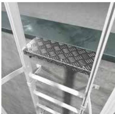
Applicabile ad ogni piolo, ma destinato al piolo di arrivo, permette un appoggio più sicuro del piede allo sbarco della scala, colmando possibili vuoti eccessivi tra scala e supporto. Gradino lungo 170 mm in lamiera pressopiegata in lega di alluminio con anti-scivolo.
