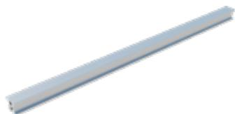
Profilo per binario rigido TIPO D realizzato per estrusione di Alluminio 6063 preforato per l'inserimento delle giunzioni. Verifica con prova in nebbia salina neutra UNI EN ISO 9227.
