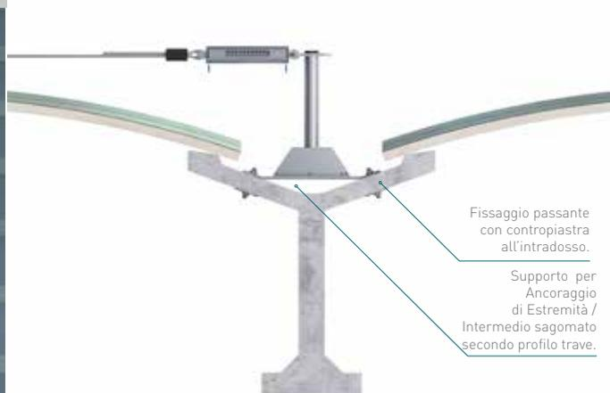
Applicazione di fissaggio con piastra rialzata ed ancorata direttamente sulla trave con fori passanti
