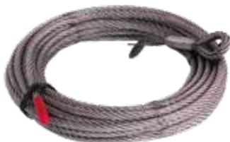
Fune in acciaio Inox AISI 316 Diam. 8mm con 133 fili. Fornita ad una estremità di occhiello chiuso con redance, manicotto in alluminio tronco conico e targhetta in alluminio con indicazione lotto di produzione.
