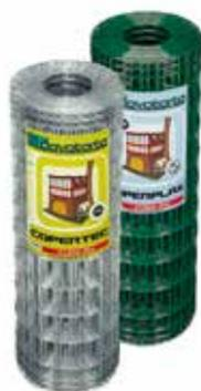
**COPERTEC:** Rete elettrosaldata con triplo vivagno alle estremità. I fili orizzontali e verticali, entrambi lineari, sono in acciaio zincato. L'impiego è finalizzato alla protezione dai rischi di caduta in fase di manutenzione delle coperture di edifici con destinazione industriale/agricola.
