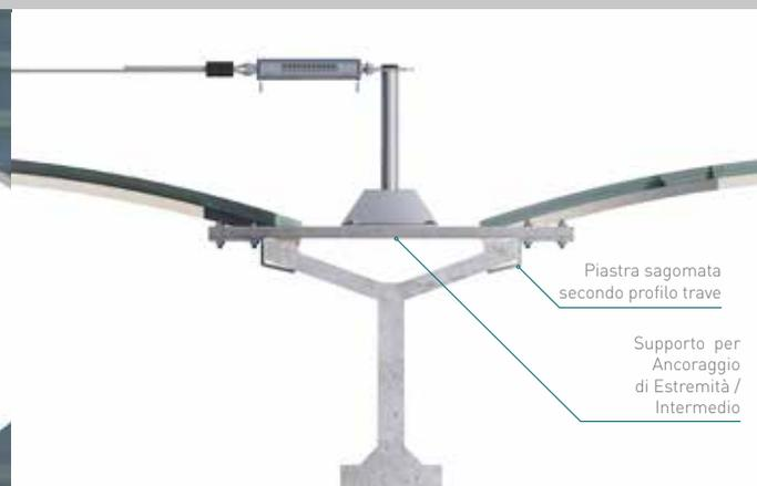
Applicazione di fissaggio con piastra ancorata direttamente sulla trave con fori passanti
