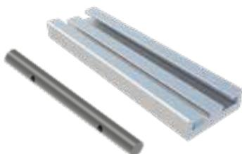
Giunzione per binario rigido TIPO D realizzato per estrusione di Alluminio 6063 preforato per l'inserimento della Bulloneria M6 di fissaggio fra i profili. Verifica con prova in nebbia salina neutra UNI EN ISO 9227.
