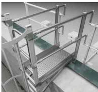
Passerella con piano di sbarco (larghezza utile 500 mm.) in alluminio con camminamento in lamiera bugnata, antiscivolo e drenante.
