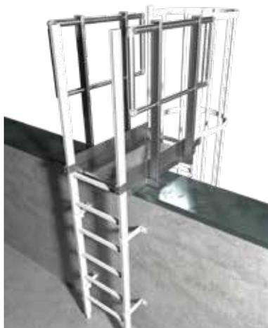
Passerella con piano di sbarco (larghezza utile 500 mm.) in alluminio con camminamento in lamiera bugnata, antiscivolo e drenante. Passerella dotata di parapetti laterali costituiti da corrimano ad un'altezza di 1100 mm, battiginocchio e fascia fermapiEDE completa di bulloneria di fissaggio.
